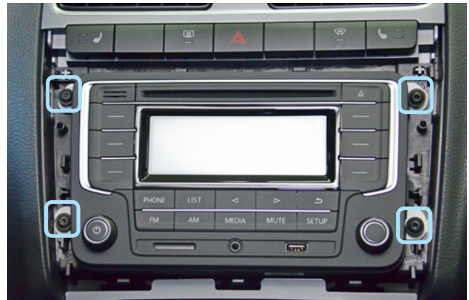
Фото 1.2. Саморезы крепления магнитолы
