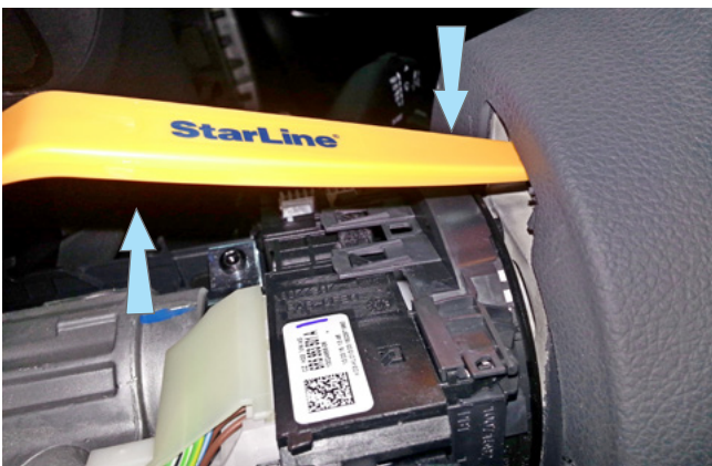
Фото 1.14. Освободить фиксатор подушки безопасности
