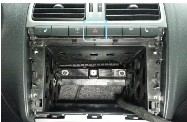
Фото 3.9. Местоположение кнопки аварийной сигнализации
