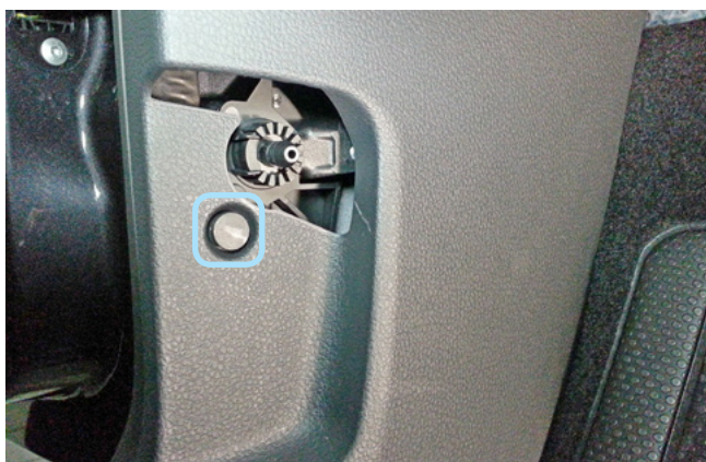
Фото 1.7. Клипса крепления кик-панели
