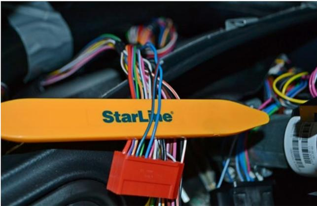
Фото 3.3. Управление световыми сигналами (синий и сине-красный)
