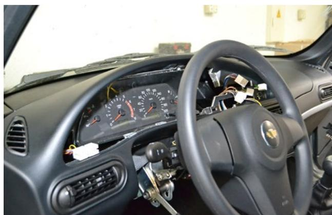
Фото 1.9. Декоративная накладка панели приборов снята
