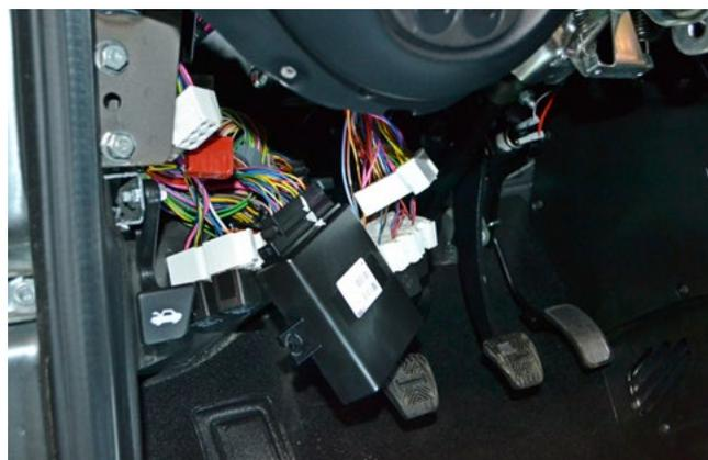
Фото 1.17. Блок штатной сигнализации снят
