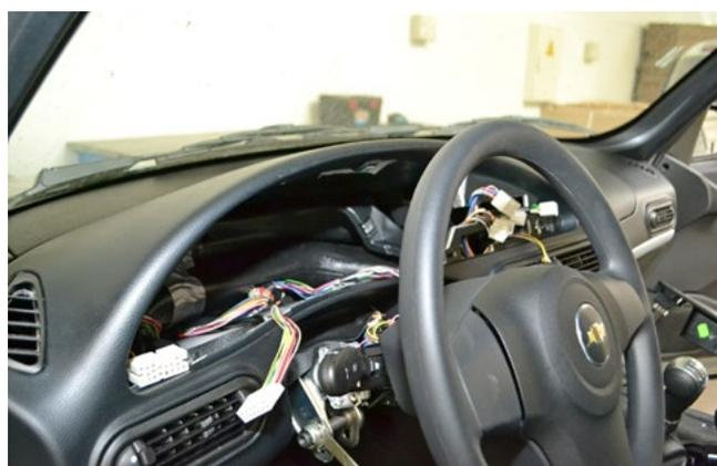
Фото 1.11. Панель приборов снята
