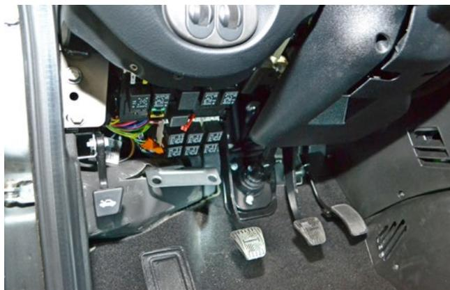
Фото 1.13. Пластиковая накладка снята
