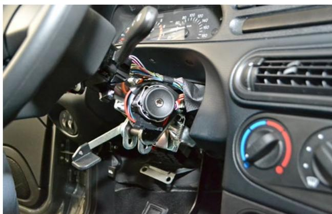
Фото 1.5. Рулевой кожух снят
