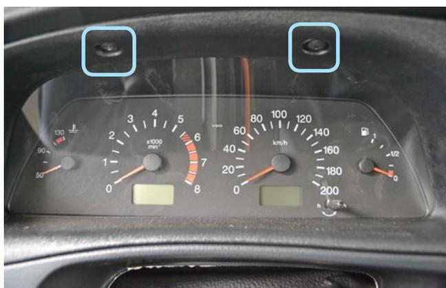
Фото 1.8. Саморезы крепления декоративной накладки панели приборов
