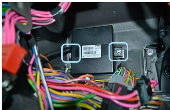
Фото 1.16. Гайки крепления блока штатной сигнализации
