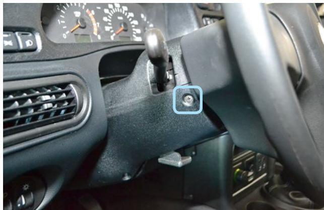
Фото 1.2. Саморез крепления нижней части рулевого кожуха
