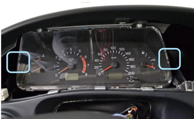
Фото 1.10. Саморезы крепления панели приборов
