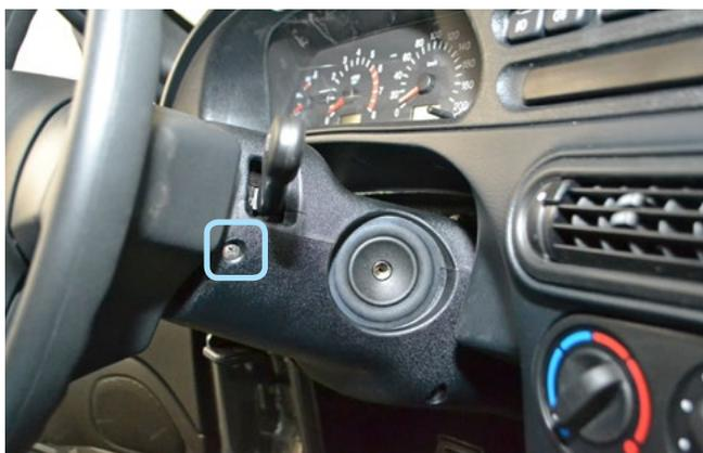
Фото 1.3. Саморез крепления нижней части рулевого кожуха
