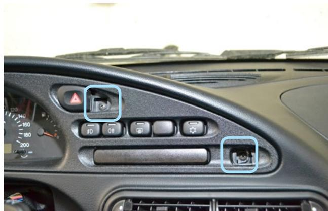
Фото 1.7. Саморезы крепления декоративной накладки панели приборов
