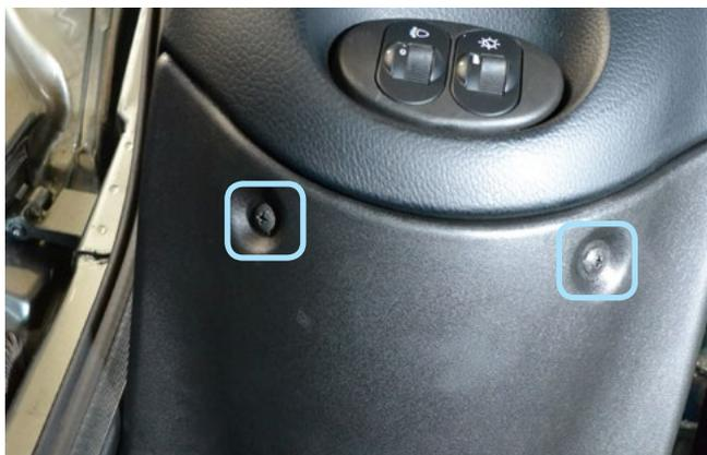
Фото 1.12. Саморезы крепления пластиковой накладки
