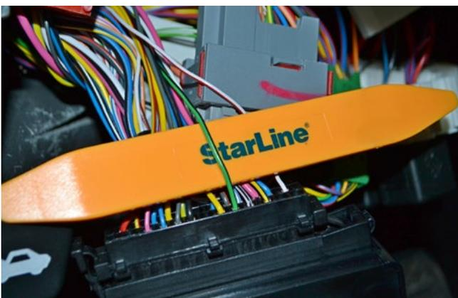
Фото 3.5. Концевик капота (зелёно-чёрный)
