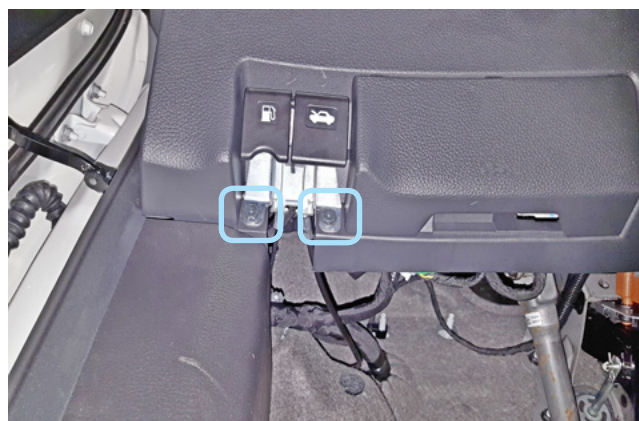
Фото 1.4. Болты крепления ручки отпирания капота
