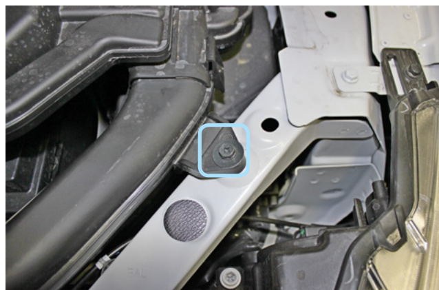
Фото 2.4. Болт крепления воздуховода
