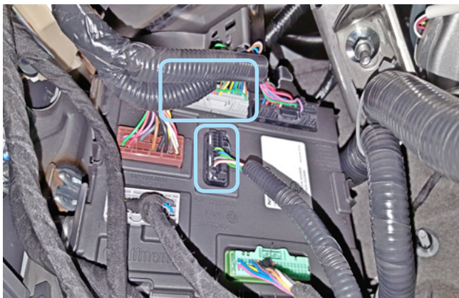
Фото 3.7. Местоположение разъёмов на блоке BCM
