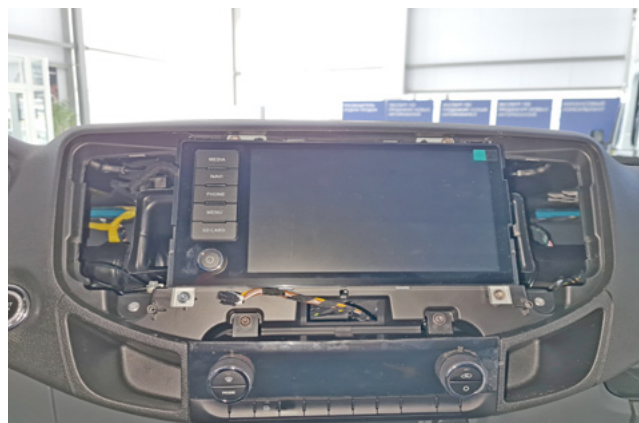
Фото 1.8. Декоративная накладка снята
