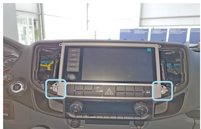
Фото 1.6. Саморезы крепления декоративной накладки мультимедиа
