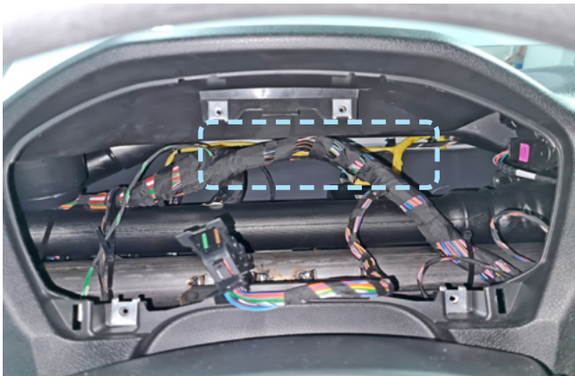
Фото 2.9. Пример расположения центрального блока охранно-телематического комплекса
