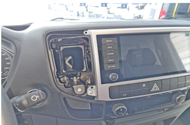
Фото 1.5. Левый центральный воздухопровод снят
