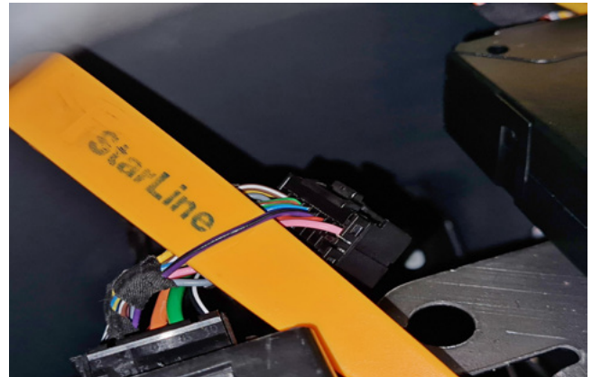
Фото 3.7. Контроль стояночного тормоза (фиолетово-чёрный)
