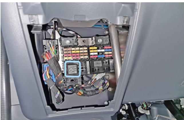
Фото 3.8. Местоположение реле на монтажном блоке предохранителей в салоне
