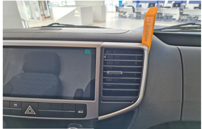
Фото 1.2. Снять правый центральный воздухопровод
