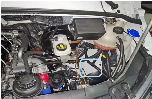
Фото 2.2. Возможное место установки сирены
