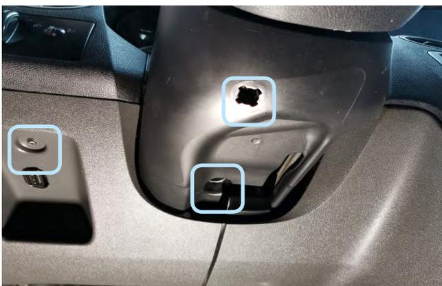
Фото 1.5. Саморезы крепления пластиковой накладки и рулевой колонкой.
