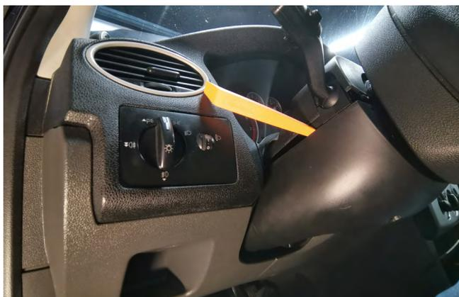
Фото 1.7. Снять нижнюю часть кожуха рулевой колонки
