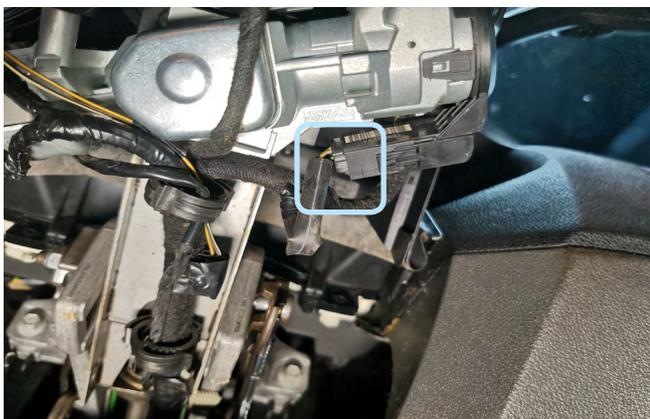
Фото 3.15. Местоположение разъёма.
