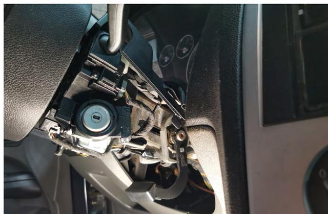
Фото 1.8. Нижняя часть кожуха рулевой колонки снята.
