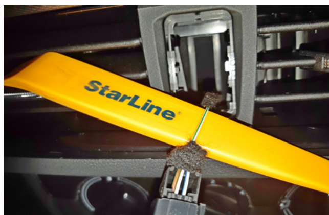
Фото 3.7. Управление световыми сигналами (бело-зелёный)
