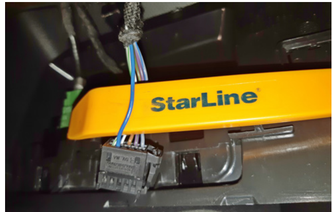
Фото 3.9. Управление центральным замком (синий)
