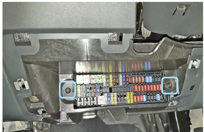
Фото 1.15. Крышка снята. Винты крепления
