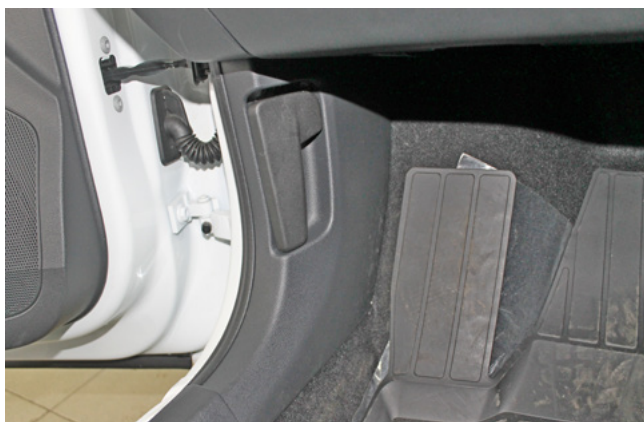
Фото 1.7. Пластиковая накладка левой кик-панели. Общий вид
