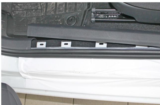
Фото 1.11. Накладка порога частично снята
