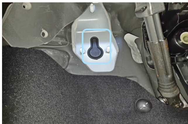
Фото 2.7. Штатный уплотнитель. Вид со стороны салона
