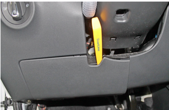
Фото 1.14. Снять пластиковую крышку блока предохранителей
