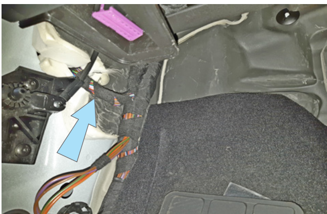
Фото 3.10. Местоположение жгута в левой кик-панели
