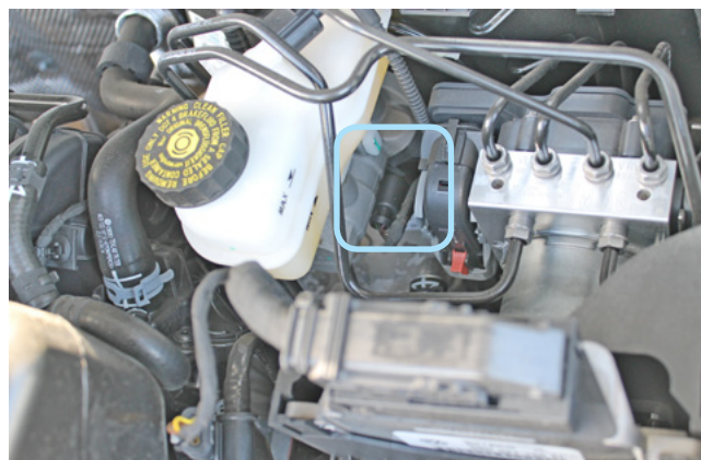
Фото 3.17. Местоположение концевика педали тормоза
