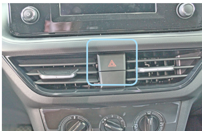
Фото 3.6. Местоположение кнопки аварийной сигнализации
