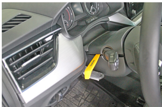
Фото 1.2. Снять верхнюю часть кожуха рулевого вала
