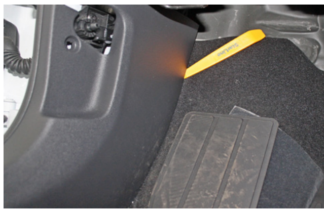
Фото 1.12. Снять пластиковую накладку левой кик-панели
