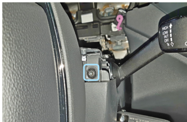
Фото 1.18. Винт крепления нижней части кожуха рулевого вала справа
