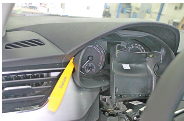
Фото 1.4. Снять декоративную накладку панели приборов
