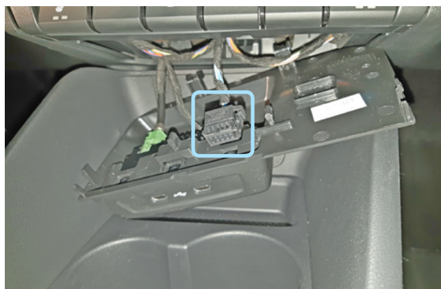
Фото 1.22. Панель снята. Разъём кнопки управления центральным замком
